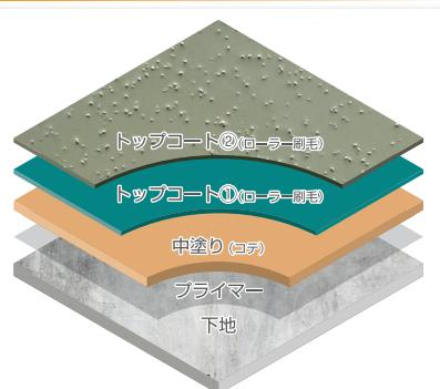
S工法 + 上塗り(骨材添加)する防滑仕上げ工法です。
