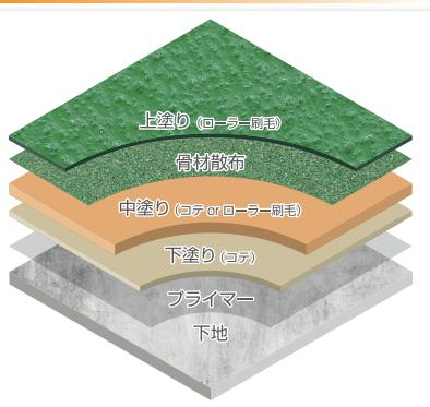
本格的防滑仕上げ工法です。(各種粒度の骨材を使用目的に応じて使い分けることが出来ます。)
