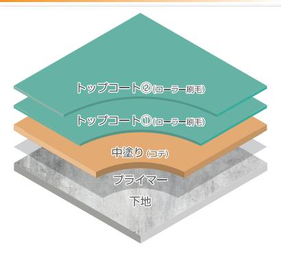
S工法施工後、耐候性を有するトップコートを施工する工法です。
