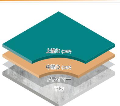
柔軟性・クラック追従性をより高める下塗り用軟質タイプを下層に施工。クッション性、耐亀裂性を向上させた工法です。
