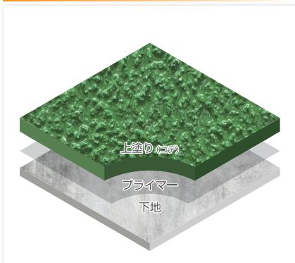
本格的防滑仕上げ工法です。(各種粒度の骨材を
